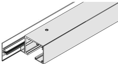
Das Profil ist ungebohrt und muss vor Ort für die Anbindung an die Laufschiene gebohrt und vorgesenkt werden.
