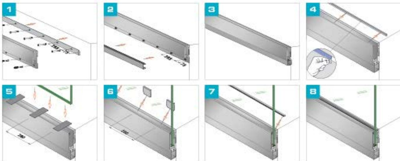
Bitte beachten Sie die Spezifikationen wie Befestigungs- und Glasmaße der jeweiligen Zertifikate. Verklötzung soll ca. alle 280 mm erfolgen. Da das System über keine Entwässerung verfügt, muss das Profil im Außenbereich mit Silikon abgedichtet werden. Bohrungen auf der Außenseite können ebenfalls Abhilfe schaffen.
