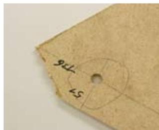
Abgebrochene Schablonen erschweren das Erkennen der Scheibenmaße und die Rekonstruktion ist sehr zeitaufwändig
