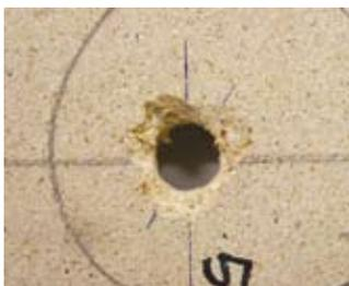
Ausgefranzte Bohrlöcher vermeiden, Bohrung durch Mittelpunkt bestimmen
