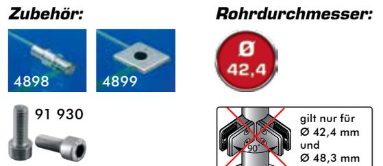
Lochbohrung für Sicherungsstift mindestens Ø 10 mm.
