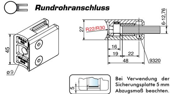
Bei Verwendung der Sicherungsplatte 5 mm Abzugsmaß beachten.
