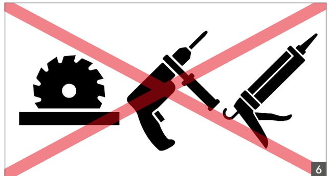
6 Kein Schneiden und kein Bohren der Profile, kein Verkleben!
