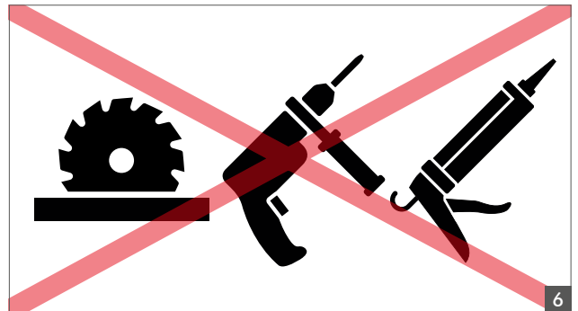
6 Kein Schneiden und kein Bohren der Profile, kein Verkleben!
