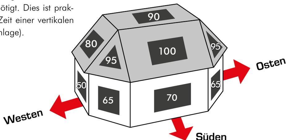
Eine PV Anlage am Dach liefert in den kalten Monaten aufgrund des niedrigend Sonnenstandes nicht das volle Energiepensum. Ein vertikales PV System bietet sich an um dieses Defizit auszugleichen und eine möglichst autarke Energieversorgung sicherzustellen. Der Jahresertrag kann signifikant gesteigert werden.
