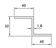
Z-Profil für die vertikale und horizontale Montage von Fassadenplatten.
