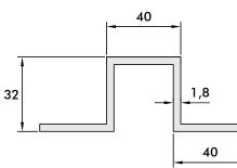
Hut-Profil für die vertikale und horizontale Montage von Fassadenplatten.
