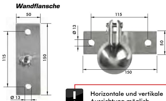
**!** Horizontale und vertikale Ausrichtung möglich.
