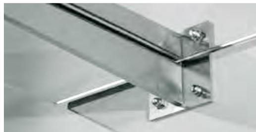
**King I - ein wahrhaft königliches Design.** Bei dieser eleganten Schwertbefestigung wird das Glas linienförmig gehalten. Bohrungen im Glas sind nicht erforderlich. Dieses Vordach bietet durch die Verwendung von Spiegelglas eine schnelle und kostengünstige Lösung. Das Vordachsystem King I ist mit zwei oder drei Kragarmen erhältlich, die Dachneigung beträgt standardmäßig 5 Grad.
