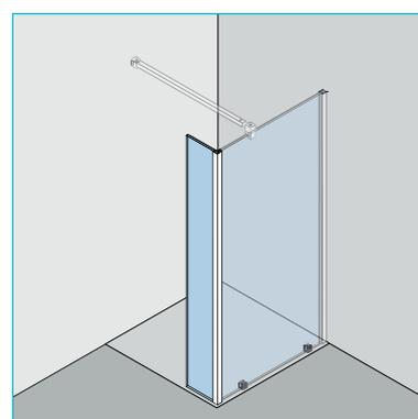
Ganzglasduschsystem Quadrat zusätzliche Seitenwand, montierbar im 90° Winkel (links oder rechts) an Quadrat Duschtypen 500/530
